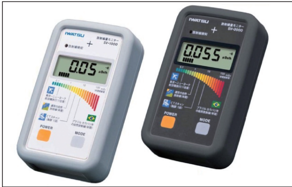
測定結果を分かりやすく表示する放射線量モニター
