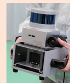
廃炉現場の汚染分布を3次元マップで「見える化」する「IRIS」
