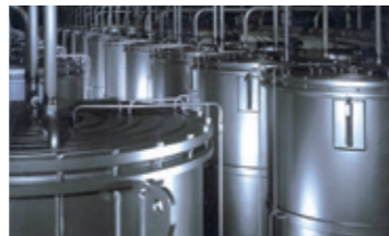
ウラン濃縮原形プラント DOP-2遠心分離機 (1989年運転開始)
