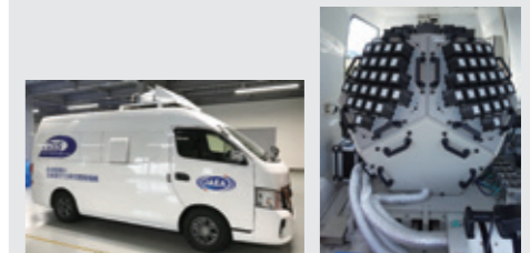
iRIS-V全景 iRIS-Vの車内に設置されているコンプトンカメラ
