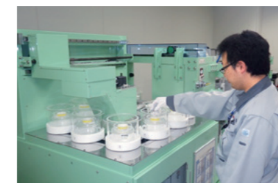
放射線(ガンマ線)計測装置 ゲルマニウム半導体検出器を用いたガンマ線の測定を行う装置。土壌等に含まれる放射性物質の種類や量に関する情報が得られる。
