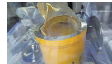
貯蔵容器の状況(現場から別の部屋のグローブボックスへ搬入後に確認)
