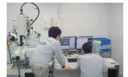
元素分析装置 電子線を試料表面に照射し、組織の観察や元素分析を行う装置。放射性物質を吸着した土壌等の化学組成に関する情報が得られる。
