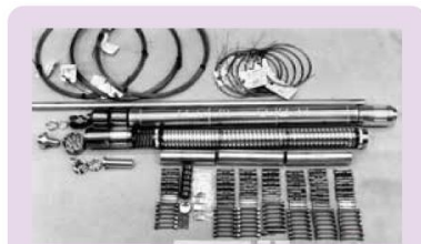
照射キャプセル(奥)と照射試験片(手前)
