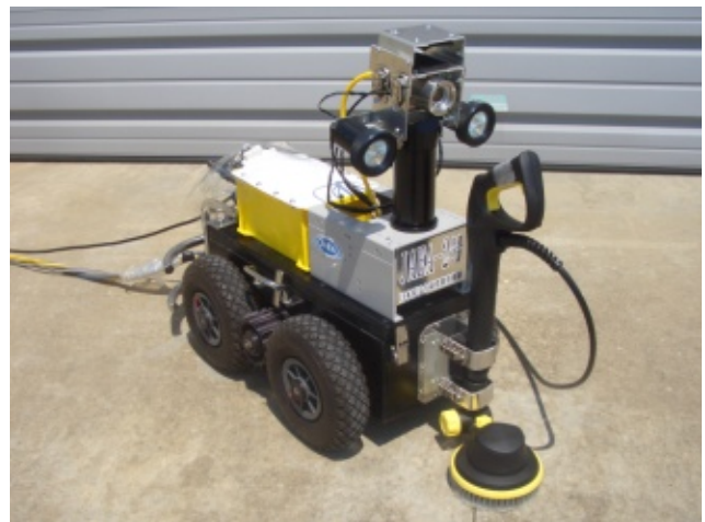
耐放射線性カメラ及び除染用 水ブラシ装備した JAEA-2 号
