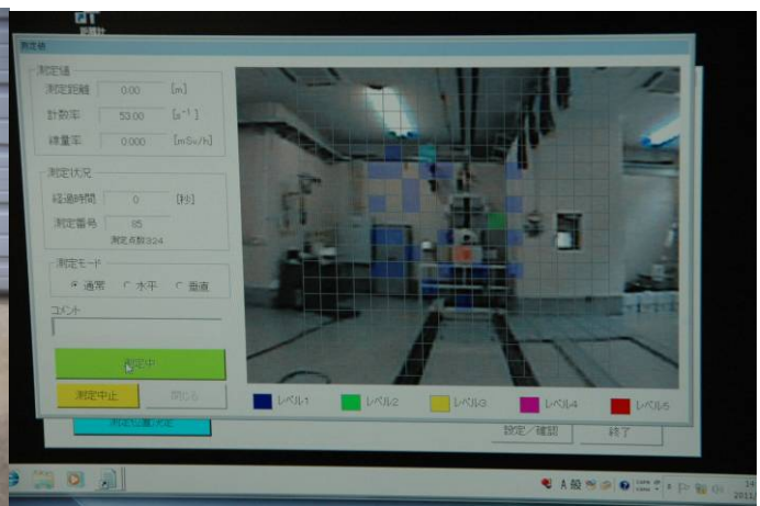
\gamma 線を可視化できるカメラ「 \gamma -eye」で、放射線源を撮影したPC画面
