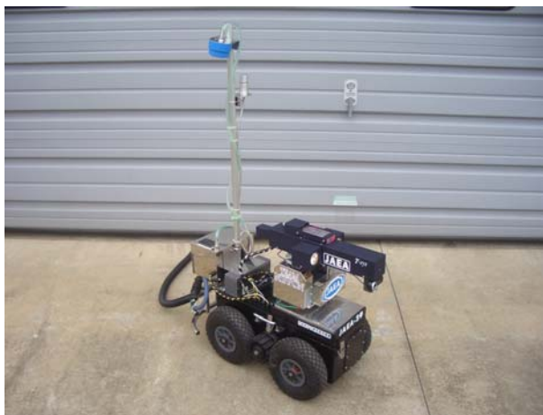
\gamma 線を可視化できるカメラ「 \gamma -eye」、放射線計測装置（GM管）、ダストサンプラ、ヨウ素サンプラを装着したJAEA-3号
