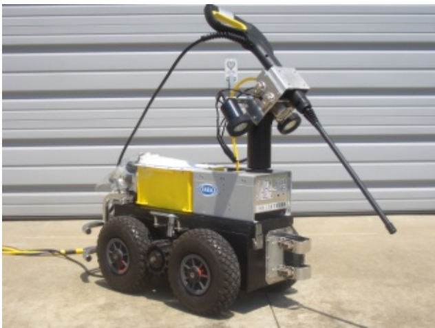
耐放射線性カメラ及び除染用 水スプレー装備した JAEA-2 号
