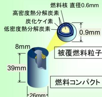
高い閉じ込め性能を有するセラミックを用いたウランの被覆
