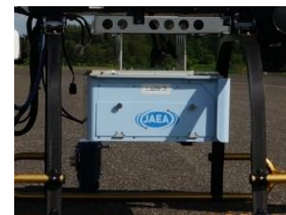
・LaBr3シンチレーション検出器(直径38mm;高さ38mm;計3本) ・同時にオルソ撮影による地形データの取得
