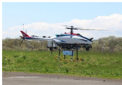
・無人ヘリコプターで高度50m、測線幅50m、速度5m/sで測定
