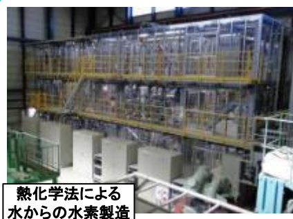
ISプロセス連続水素製造 試験装置
