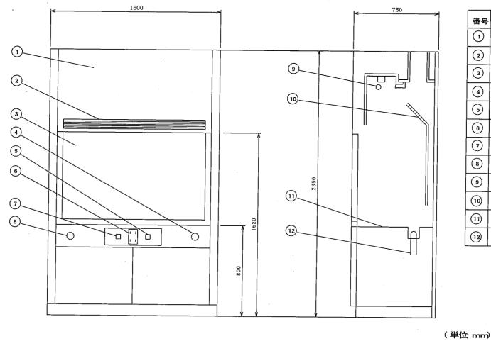
番号 部品名称 1 本体 2 給気ギャラリ 3 スライド 式ガラス窓 4 ガスハンドル 5 蛍光灯用スイッチ 6 電源コンセント  $\overline{\bigcirc}$ 電源用表示ランプ 8 給水ハンド ル 9 蛍 光 灯 10 バッフルプレート (11) 鉛張り流し (12) 排 水 管
