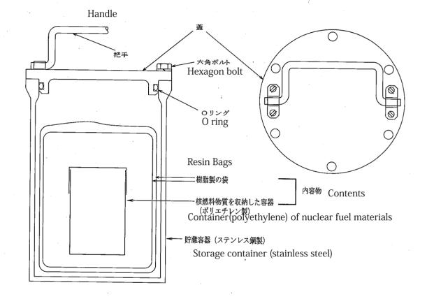
図2 プルトニウム・濃縮ウラン貯蔵容器の構造と内容物 Fig.2 Structure and contents of Plutonium and enriched Uranium storage container
