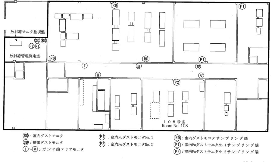
図13 燃料研究棟の放射線管理モニタの配置図
