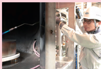
サイクル施設火災実験装置 (ACUA)
