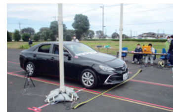
可搬型ゲート型モニタを使用した測定実験
