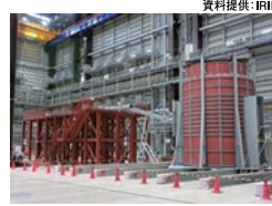
PCV内部調査用モックアップ試験設備 (実物大試験設備)
