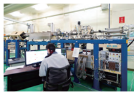
【東濃】土岐地球年代学研究所における年代測定の例 (ベレット年代測定装置 JAEA-AMS-TONO-5MV)
