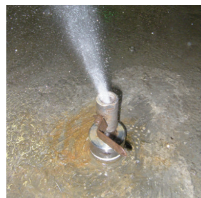
地下施設では岩盤に装置をつけることで直に試料を得ることができる。
