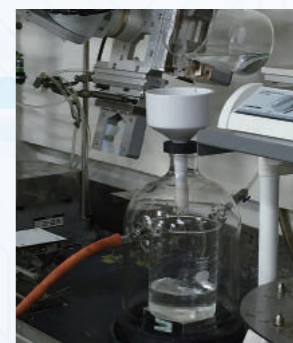
③ろ過 ②で生成した沈殿物とろ液を分離する。
