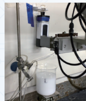
②沈殿生成・試薬の添加 自動で試薬を添加し、沈殿をつくる。
