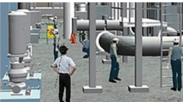
図1 「ふげん」の現場を 実寸大で仮想体験できる MRシステム
