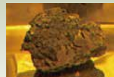
スリーマイル島 原子力発電所から 取り出した燃料デブリ 幅約10cm、重さ1.6kg 程度、原子炉圧力容器内 の溶けて固まった核燃料 がある部分から採取され た大きなかけら
