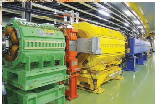
50GeVシンクロトロン(円形加速器) 1周約1600m、直径がおよそ500m の日本最大の陽子加速器
