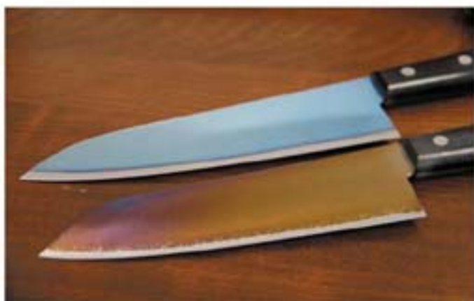
●明色の包丁は、チタンとステンレス鋼の接合面に化合物ができたもの。刃先の刃の部分が化合物(写真下)。青色の包丁には接合面に化合物がないため、刃先は見えませんが(写真上)。
