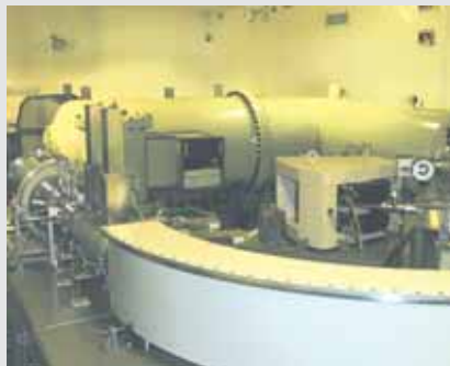
●左に見える筒状の装置がヨウ素の検出器。中央の箱形 部分が炭素の検出部。
