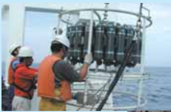
■海水の試料を採取する装置 をウインチで海の中に投入 する。
