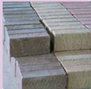
●掘削土はセメントで固められ、色とりどりのレンガに加工される。
