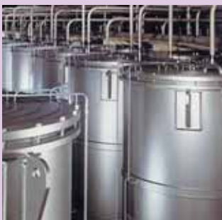
●カスケードと呼ばれる複数の遠心分離機を 組み合わせた装置でウランを濃縮する。
