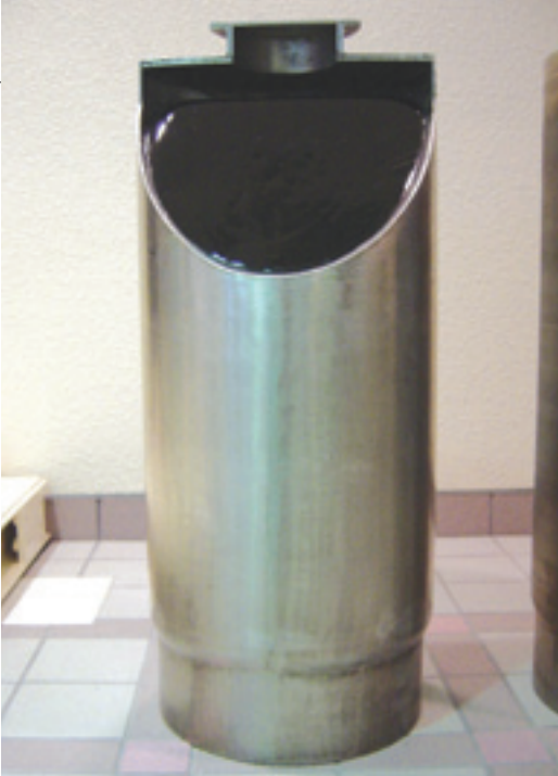
ガラス個化体 ガラス溶融炉で溶融したガラスをステンレス性のガラス個化体容器に注入・収納し、空気で冷却保管します。 ※東海再処理施設で製造されたガラス個化体 高さ:104cm 外径:43cm 重さ:400kg
