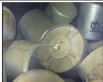
高放射性固体廃棄物缶 高放射性廃棄物貯蔵庫 (HASWS)
