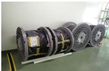
可搬型蒸気供給設備 (本設備が使用できない場合の漏えい液移送用蒸気設備)
