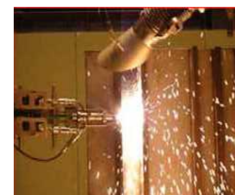
レーザー切断
