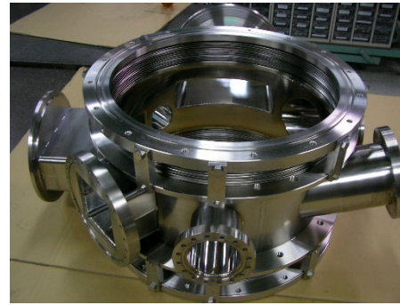
J-PARC加速器で使用しているチタン製真空容器とベローズの例
