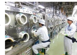
地下環境を模擬したグ ローブボックスにおけ る放射性物質移行デー タの取得
