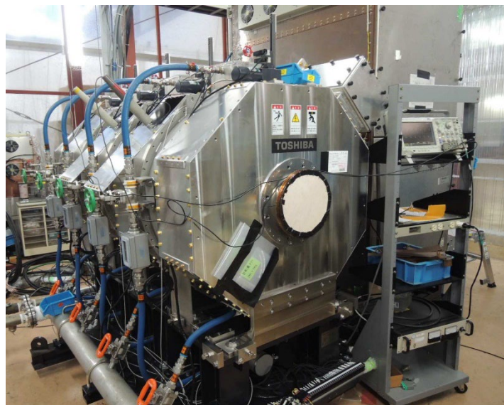
加速器トンネルに設置したシングルエンド型加速空洞
