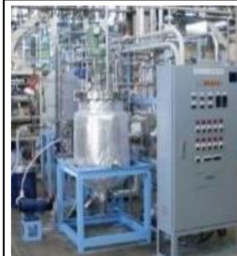
硝酸根分解試験装置 (1/25スケール)
