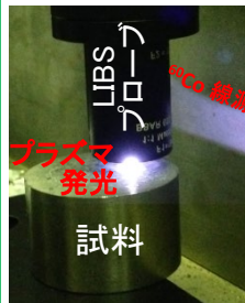
高線量率 (10kGy/h 60 Co) 環境下での試験 (QST高崎) Ce (U模擬) 酸化物中のGdに対する検量線
