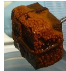
錆が付着した炭素鋼
