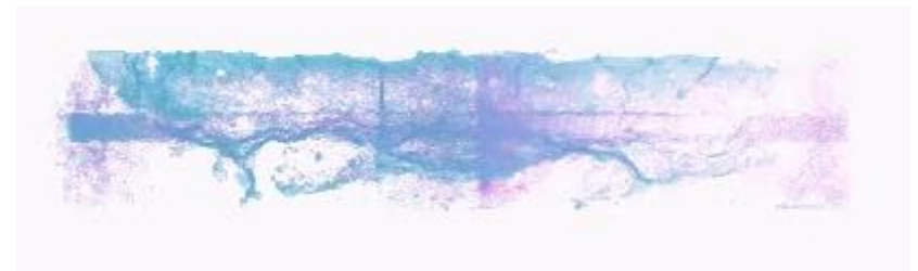
中性子CT(補修材充填状態)
