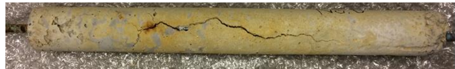
試験体(鉄筋とコンクリート)
