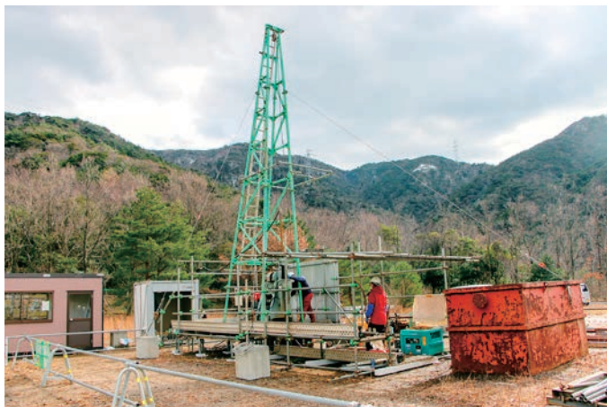
「もんじゅ」サイト(敷地内)におけるボーリング調査の様子(令和3年1月18日撮影)
