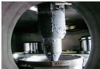
写真② Na化合物が付着したグリッパ外観
