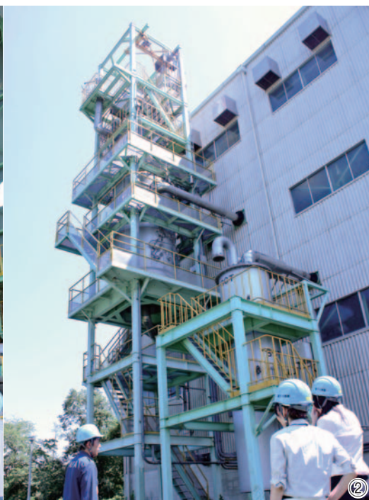
【SWAT-3Rの建屋裏】ナトリウムと水の化学反応で発生する水素を少しずつ燃焼させ、外に逃がす設備
