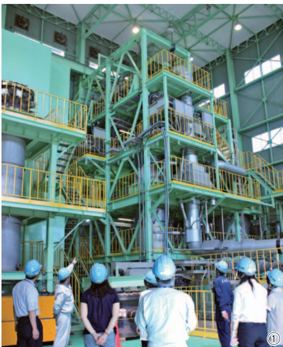
【SWAT-3R】蒸気発生器を部分的に模擬し、ナトリウムと水の化学反応による影響を調べる試験装置
