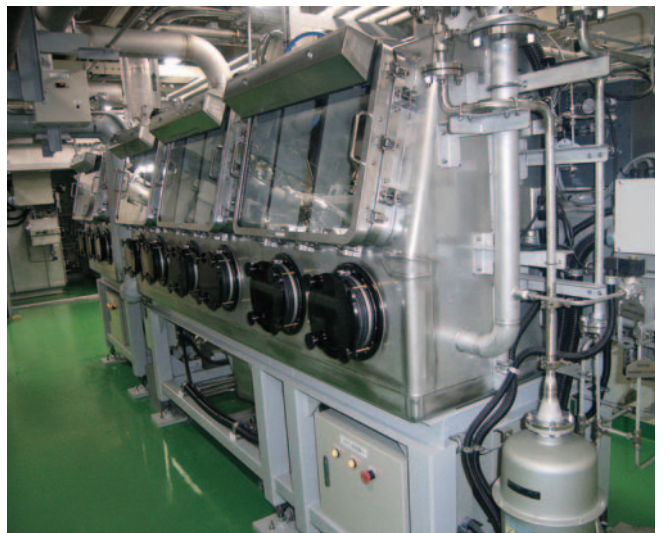
グローブをはめた手でボックスの中の物を触る試験で使う装置（グローブボックス型ナトリウム環境模擬試験設備）
