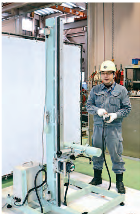
清水工業の試作品。円筒の方向にレーザー切断ヘッドが見立ても上下に動く
