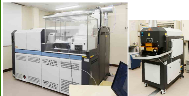
【ウラン-鉛法による放射年代測定で使用している質量分析装置(私の相棒)】
