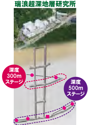
図1 花崗岩試料の採取場所 ● 岩石ブロック試料 ● ボーリングコア試料
