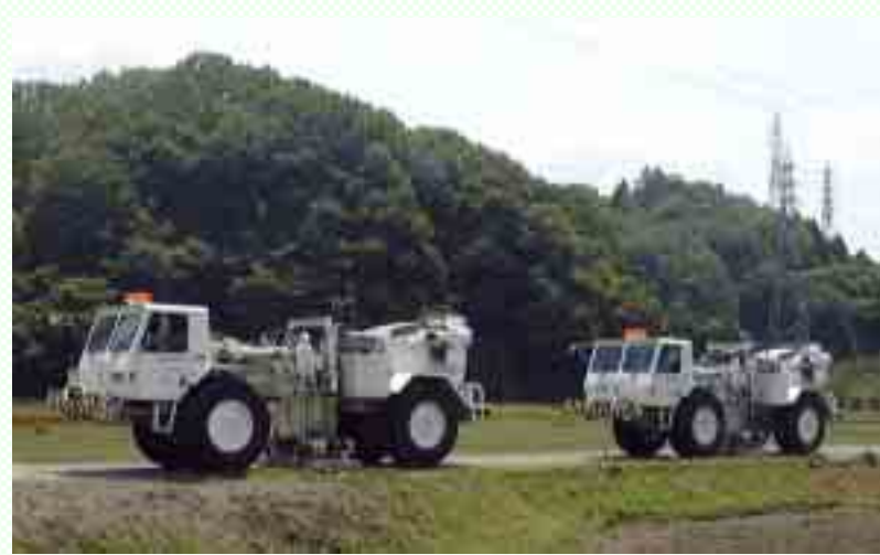
人工的な振動によって地下を調べている様子
