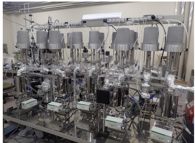
希ガス質量分析装置の全自動前処理ライン
