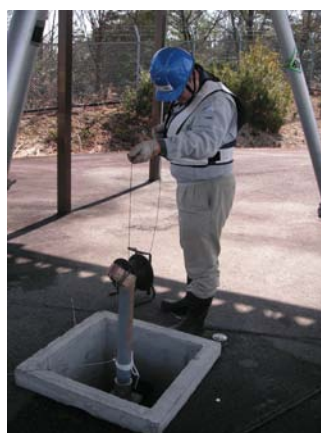
地下水の水位観測
