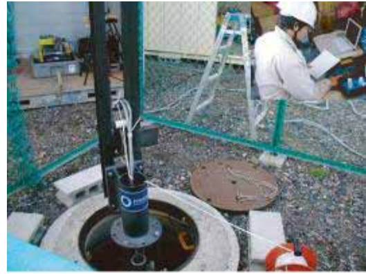
地下水の採水・化学分析
