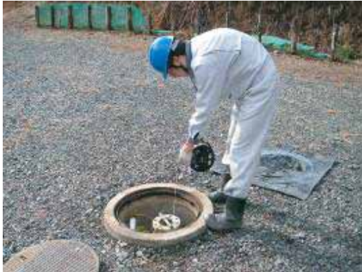
地下水の水位観測
