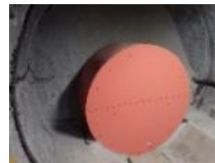
地下環境で回収技術の実証試験： 横置き・PEM方式（2015~）
