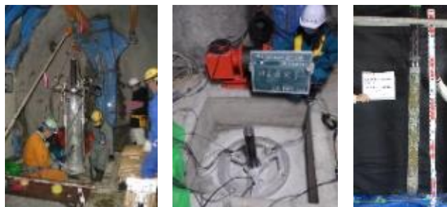
オーバーパック溶接部の腐食試験(2013~2017)
