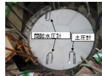
人工バリア性能確認試験への適用：7体設置（2014~）
