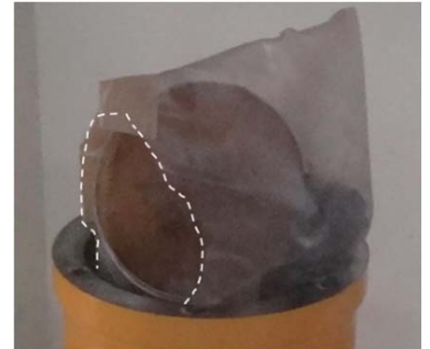
【破裂した樹脂製袋】
