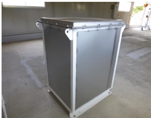
写真 2.1.11-4 撤去した変圧器を収納した SUS 製容器 (志賀 英治)
