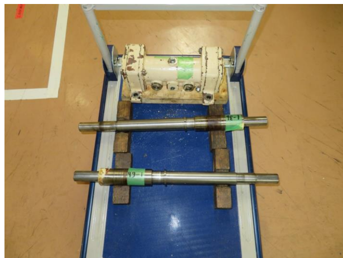
写真 2.1.8-1 分解後の既設の軸受ユニット及びシャフト
