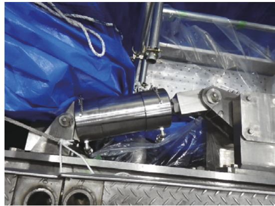
写真 3.1.2.2 駆動用水圧シリンダ 更新後 (今橋 正樹)
