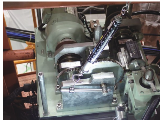
写真 3.1.2.5 起動系駆動装置の機能検査
