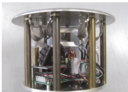
図 3.8.4 試作した電圧測定器の内部。実機に設置する際にはアルミ板でシールドする。
