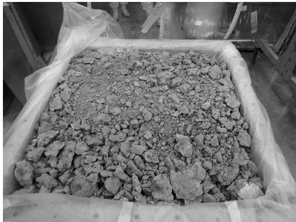
図 3.4.2-2 JRR-4 から発生した S-I 容器の内容物
