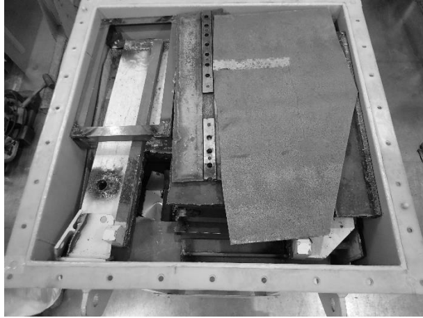
図 3.4.2-1 JRR-2 から発生した S-I 容器の内容物
