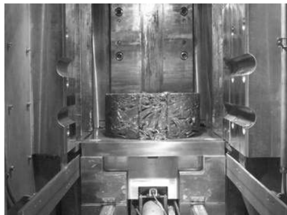
模擬廃棄物①の圧縮状況
