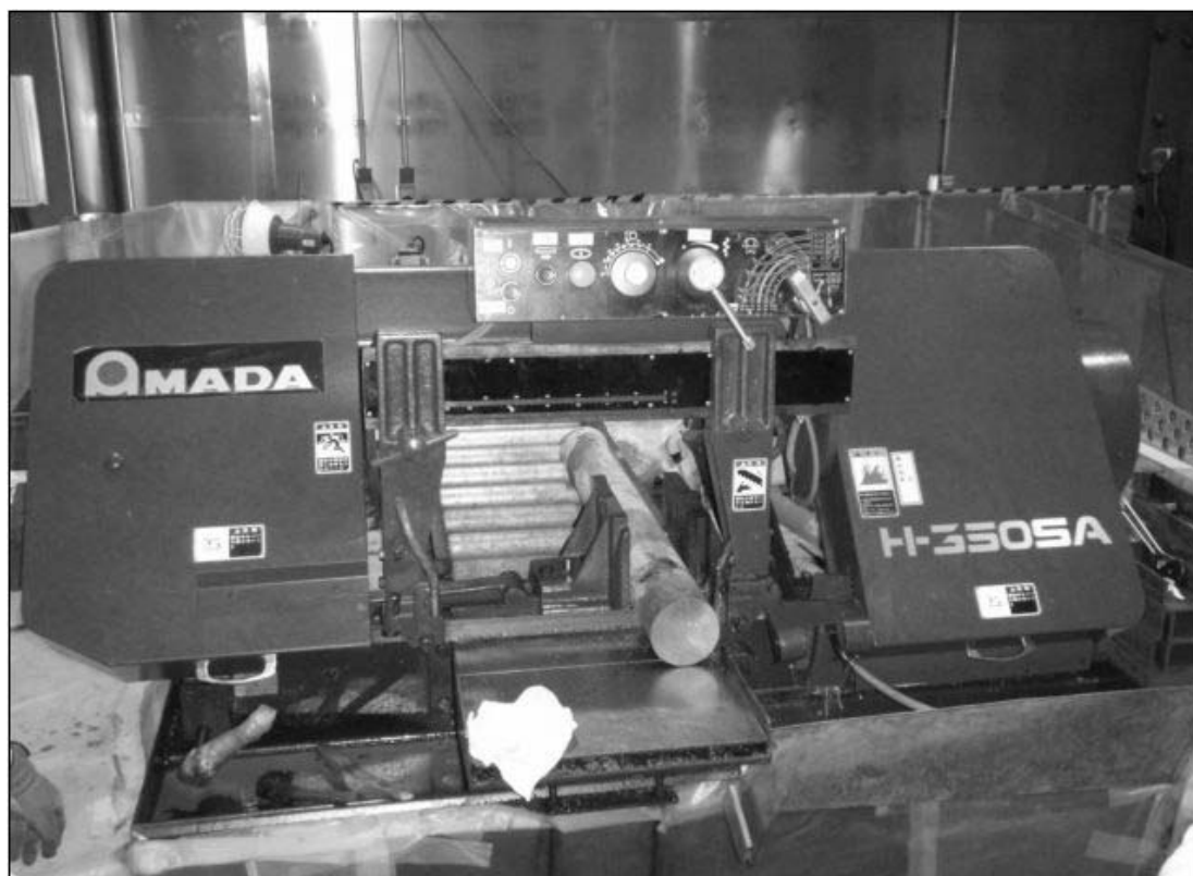
図 3.4.2-6 大型バンドソーによる切断作業
