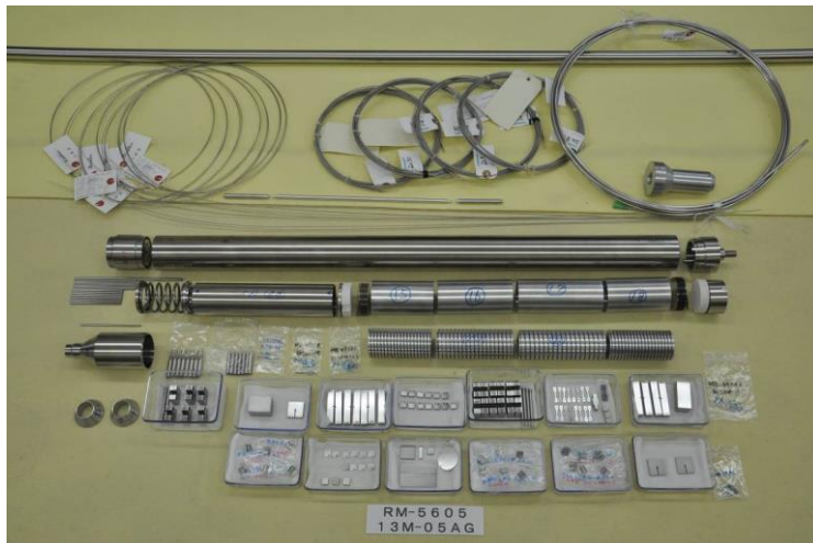
図IV-5-3 照射脆化評価用キャプセル構成部品及び照射試料
