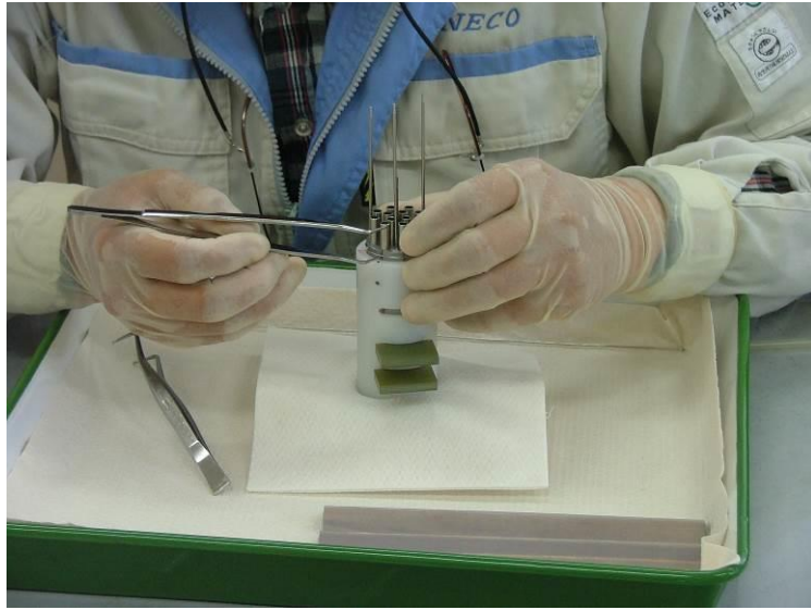
図IV-5-2 耐酸化黒鉛照射試験用キャプセル照射試料組込作業
