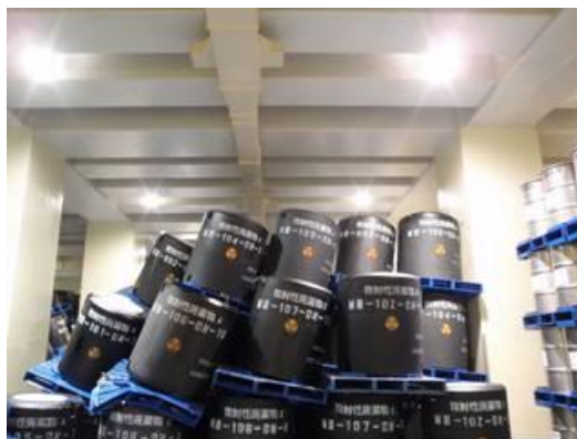
保管体荷崩れの状況
