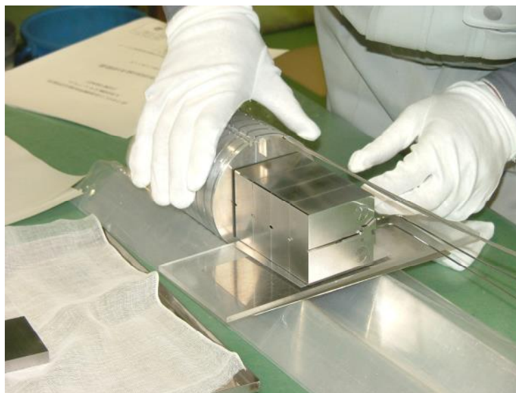
図Ⅲ-6-2 破壊靱性評価キャプセル照射試料組込作業
