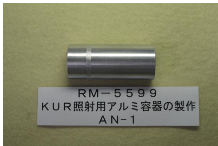
図Ⅲ-6-1 Mo/Tc 製造実用化技術開発 KUR (京大炉) 照射用アルミ容器
