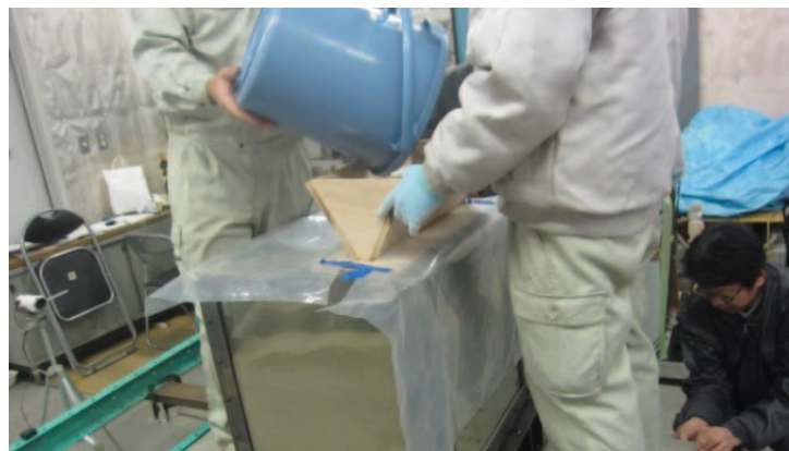
図 3-23 土槽へ砂を投入する投入箱と投入状況
