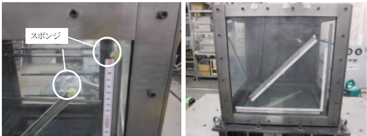
図 4-8 ガラス面に設置した細管 (パターン A : 2G-30Hz-空気抜き 10 分加振)
